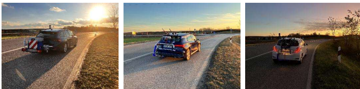
3. ábra. PEMS hordozható emissziómérővel végzett vizsgálatok Forrás: saját forrás (2025-2026)
